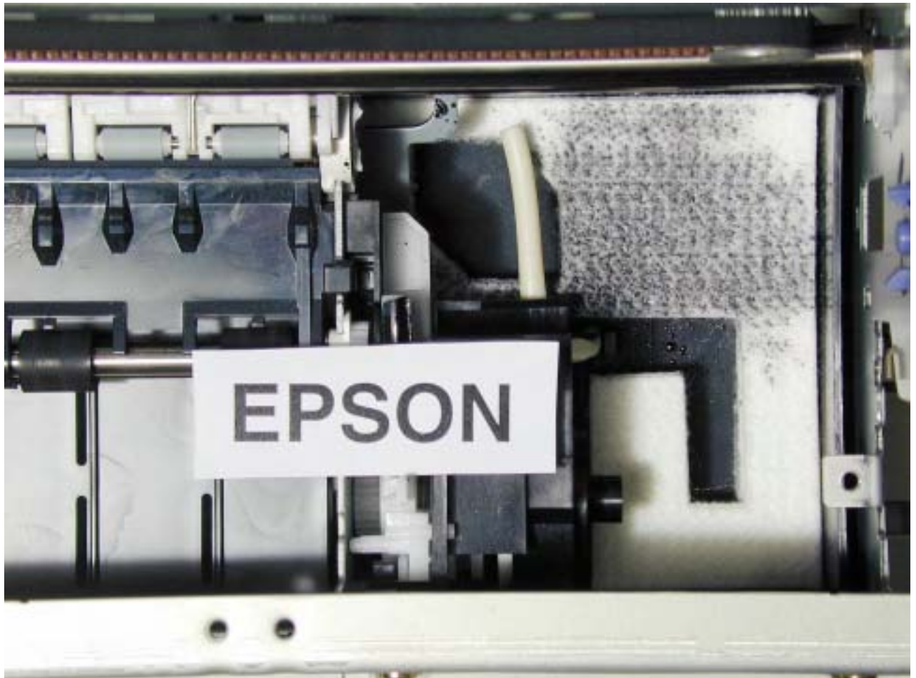
Abbildung 3 : Drucker mit Epson-Tinte, Fliess unter der Ansaugereinrichtung
